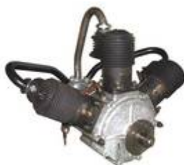
Moteur Anzani 3 cylindres de 1909 (traversée de la Manche)
