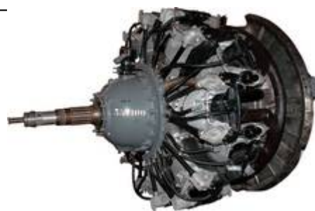
Moteur Pratt & Whitney double étoile fixe de 18 cylindres (2 x 9) - Année 1930
