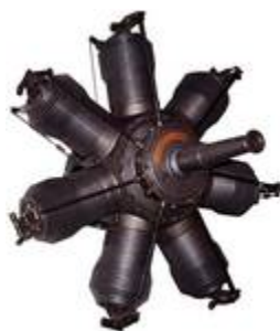
Moteur Gnome rotatif 7 cylindres de 1909
