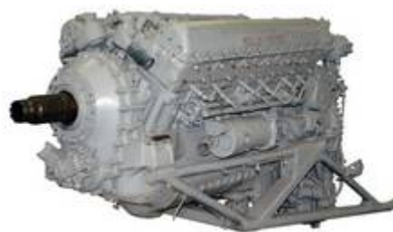
Moteur V12 Merlin Rolls-Royce de 1936
