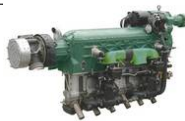
Moteur Renault 6 cylindres inversés de 1926
